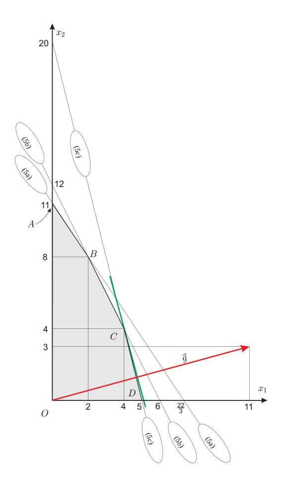
Итак, максимальное значение целевой функции  $f(x_1,x_2,x_3)$  достигается при  $x_1=4,\ x_2=4,\ x_3=0$  и равно 80.
