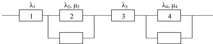
Рисунок 13 – Структурная схема восстанавливаемой системы
