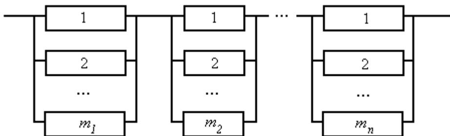
Рисунок 10 – Структурная схема системы с отдельным резервированием
