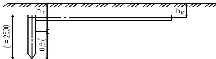
Рис. 1.1. Размещение сложного заземлителя в земле
